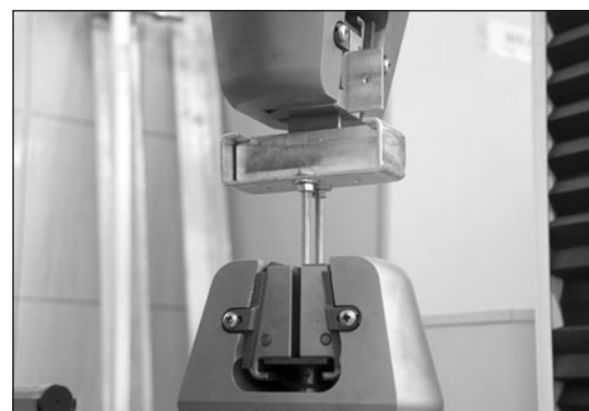
Рис. 3. Установка с образцом для испытания узлового соединения
