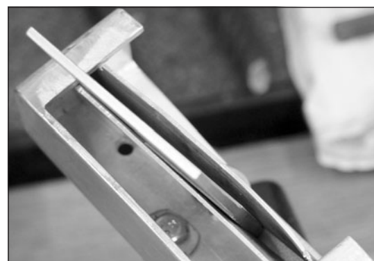
Рис. 4. Общий вид узлового соединения после испытания
